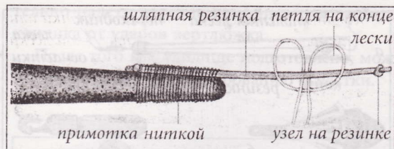
Рис. 2. Внешний амортизатор из шляпной резинки
